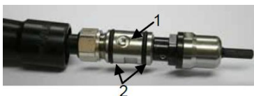
Rys.6. Otwór do smarowania na końcówce przyłączanej do wiertarki. Na zdjęciu widać zsunięty uchwyt.
