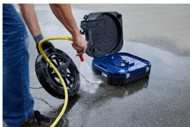
Rys. 75: Czyszczenie kołowrotka i drążka
