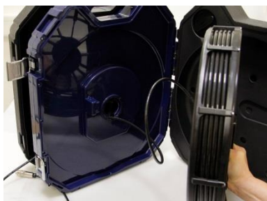
Rys. 73: Wyjmowanie kołowrotka z kablem połączeniowym z walizki.
