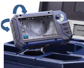
Rys. 12: Monitor można obracać i uchylać
