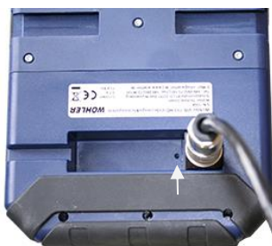
Rys. 67: Otwór resetowania oznaczony strzałką
