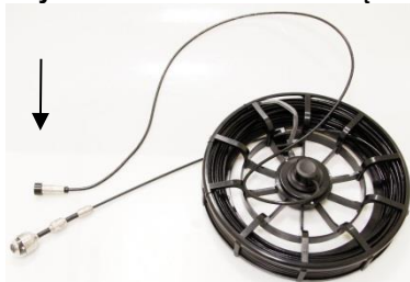
Rys. 74: Kołowrotek wyjęty z obudowy, wtyczka monitora zakryta pokrywą
