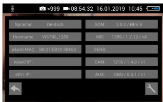
Rys. 52: Menu informacyjne z SOM (pprogramowanie sprzętowe kamery) i CAM (wersja głowicy kamery)
