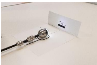
Rys. 47: Kalibracja przy użyciu szablonu kalibracyjnego
