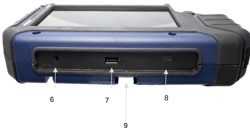
Rys. 8: Widok od spodu monitora z listwą połączeniową
