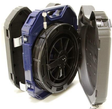
Rys. 71: Walizka w prawidłowej pozycji do demontażu kołowrotka
