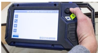
Rys. 15: Przy wyciągniętym uchwycie możliwe jest trzymanie i obsługa monitora jedną ręką.
