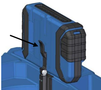
Rys. 14: Naciśnij dźwignię, aby zwolnić monitor z uchwytu
