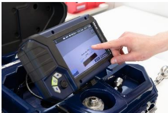
Rys. 50: Ustawienie punktu początkowego i końcowego segmentu pomiarowego.
